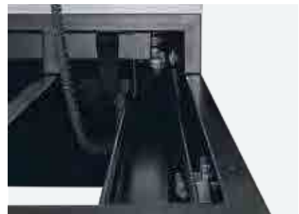
Kabelkanal über die gesamte Tischlänge und Kabelschlepper gegen Einklemmen der Kabel
