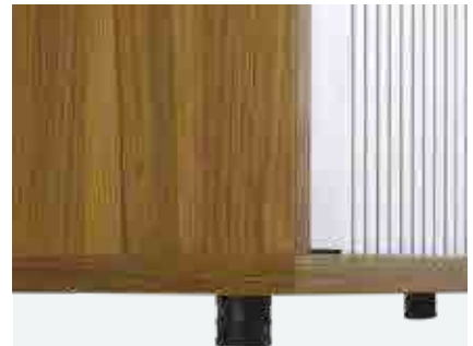
Stellfüsse Kunststoff 3,5 cm hoch, Niveaueausgleich 15 mm, Farbe: Schwarz
