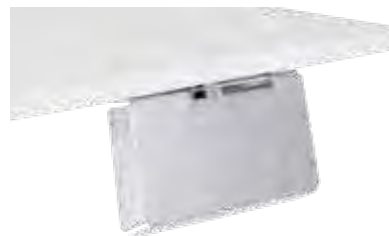
SCHREIBZEUGSCHALE FÜR GE UND GD Am Tischblatt fest montiert und abklappbar Schreibzeugschale Aluminium eloxiert optimal bei Schrägstellung: 250 x 140 x 90 mm (B x T x H)
